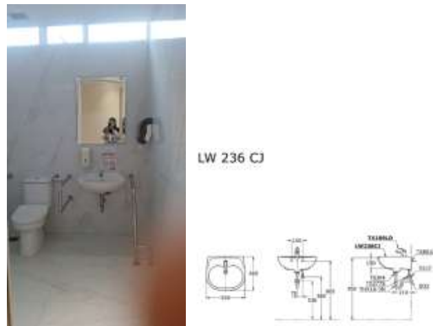
Gambar 10. Wastafel Aksesibel dengan Knee Clearance Untuk Kursi Roda
